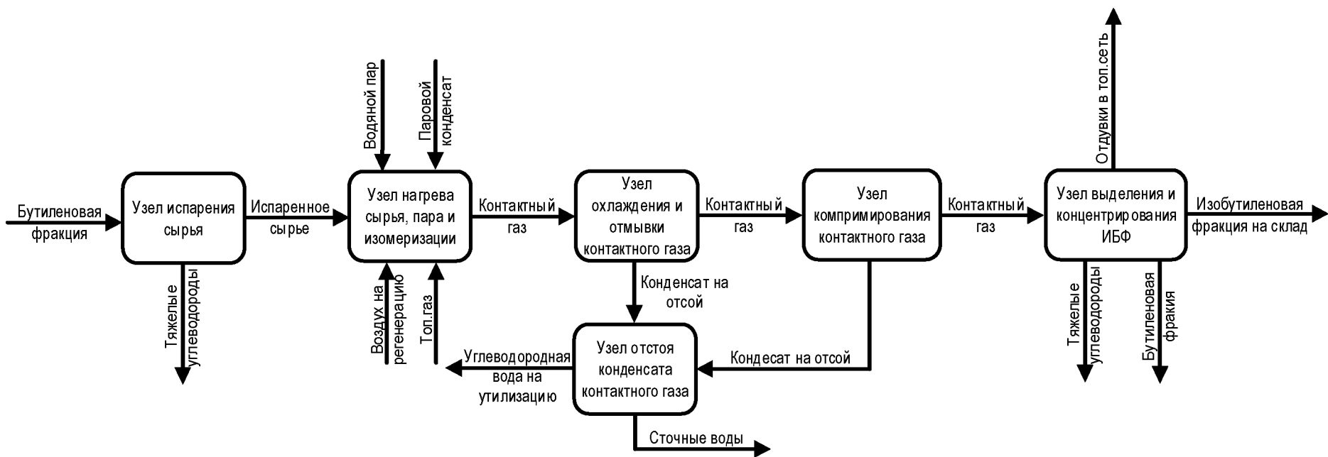
Рисунок 2.3.2 – Блок-схема процесса изомеризации нормальных бутенов в изобутилен
